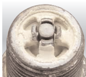
Dépôts résiduels de gas d'enfouissement Depósitos de gas de vertedero
